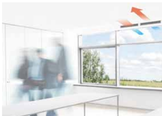
III 2 - Varmegenvinding med regenerator Når luften fra lokalet suges ud, bliver varmen akkumuleret i mikroventilationsenhedens indbyggede regenerator. Illustration fra InVentilate
